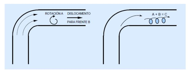
Rotación inducida por una curvatura de la tubería.
