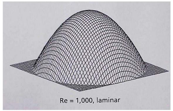
La velocidad máxima en el centro De la tubería es el doble de la media
