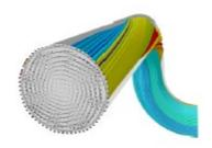
Los medidores de flujo están diseñados para ser utilizados en condiciones "ideales", pero en realidad necesitan hacer frente a válvulas y codos que distorsionan el flujo, además de ruido electromagnético, ruido acústico, partículas y burbujas, por nombrar solo algunos y todos ellos son fuentes potenciales de error.
