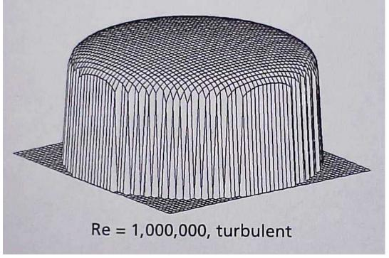
La velocidad máxima en el centrode la tubería está entre 1.1 y 1.3 veces el promedio de velocidad.
