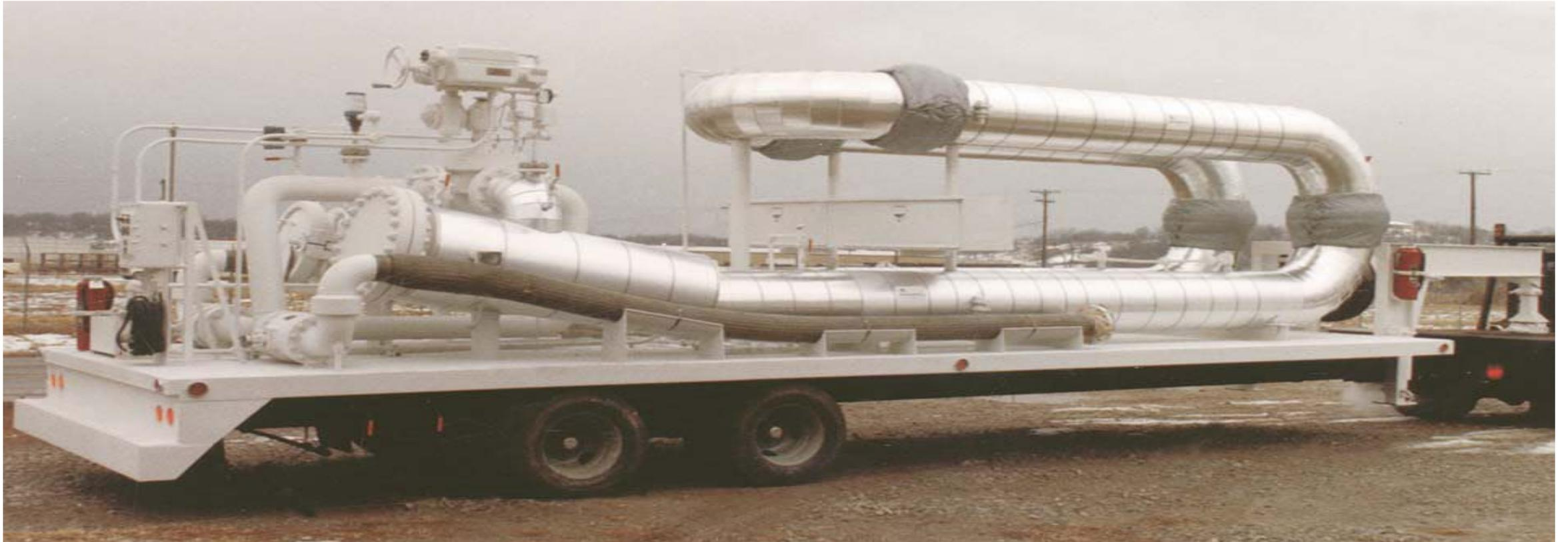
**Probador del tipo Bidireccional (Escorpión) Portátil con Cámaras a 22 Grados**
