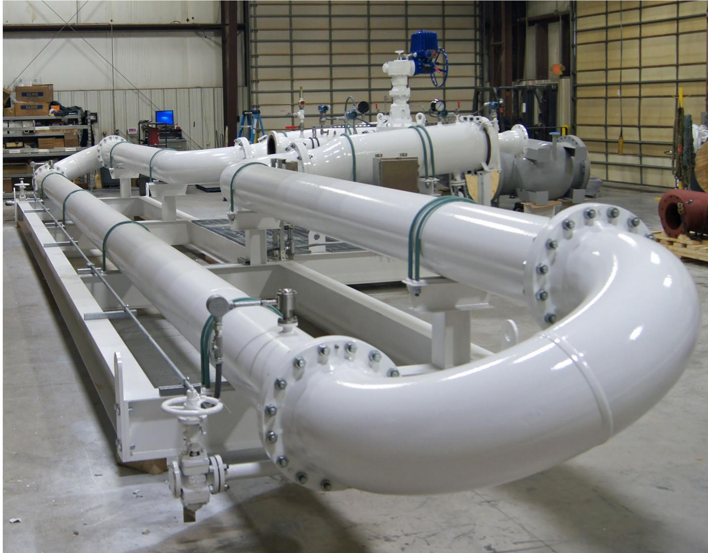
**Probador Bidireccional de Sección Calibrada Recta**
